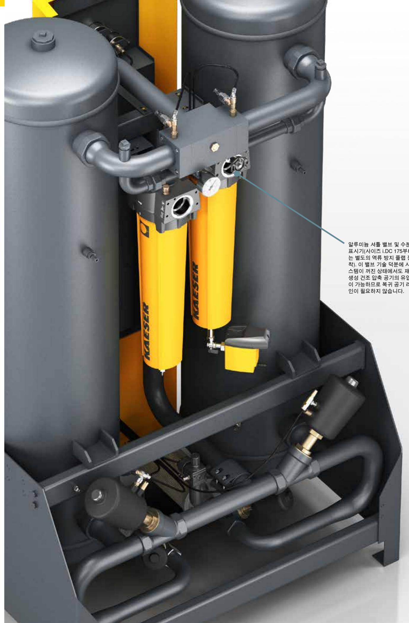
알루미늄 서플 밸브 및 수분 표시기(사이즈 i.DC 175부터는 별도의 역류 방지 플랩 장착). 이 밸브 기술 덕분에 시스템이 꺼진 상태에서도 재생 건조 압축 공기의 유입이 가능하므로 복귀 공기라인이 필요하지 않습니다.
