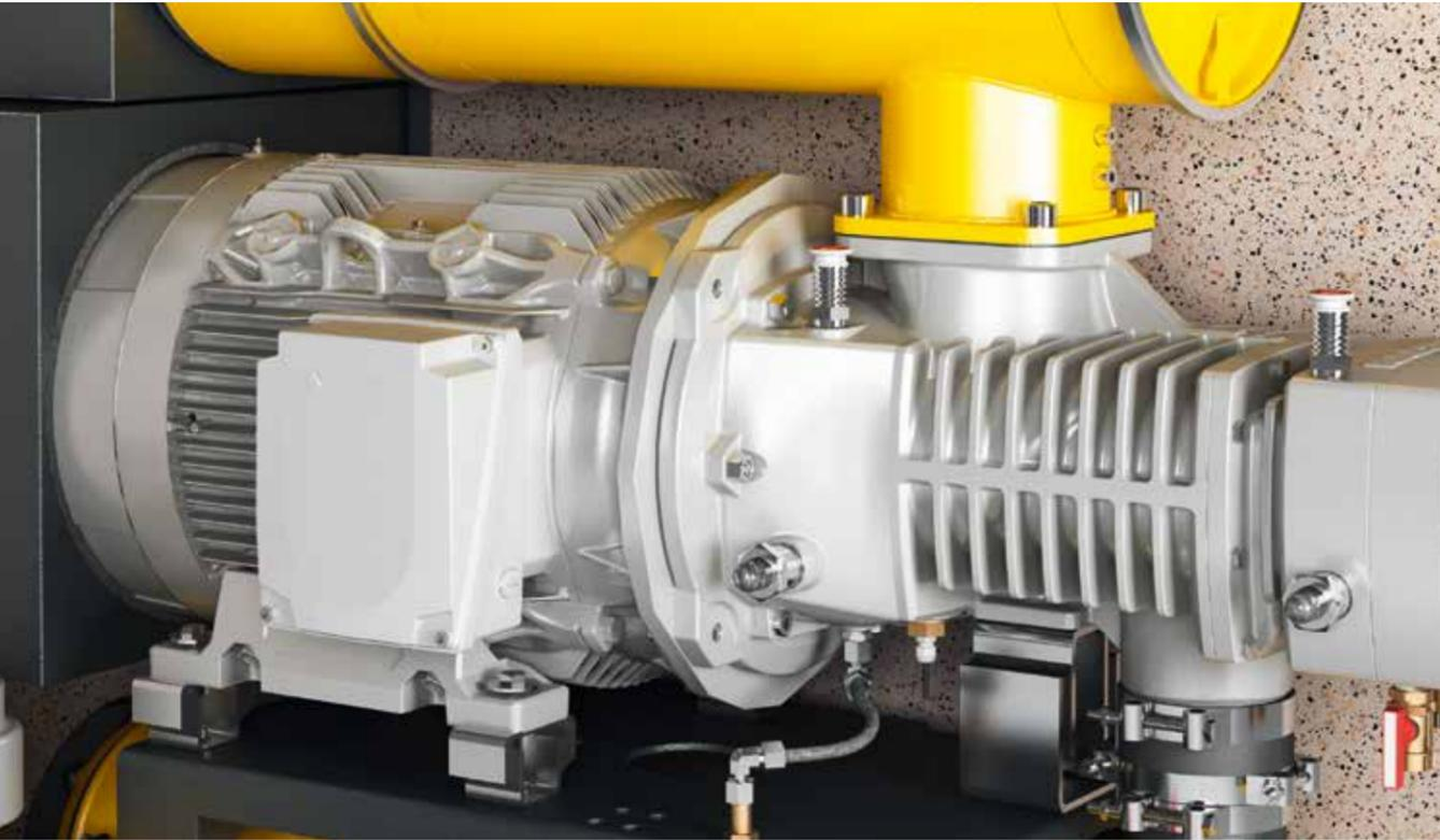
CBS~GBS 시리즈 로터리 스크류 블로워에서는 손실이 없고 유지보수가 필요 없는 기어 트랜스미션을 통해 모터에서 블로워 에어엔드로 출력이 전달됩니다. 이는 효율성, 신뢰성 및 내구성 면에서 이러한 성능 및 크기 등급의 일반적인 속도에 대한 최고의 솔루션으로 입증되었습니다.
